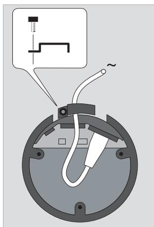
**Collier de serrage :** Pour des raisons de sécurité, le cordon secteur doit être fixé à l'enceinte à l'aide du collier de serrage fourni. Le collier de serrage maintient aussi bien le cordon secteur que le câble de l'enceinte.
