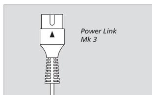
**Câbles Power Link :** Les câbles Power Link doivent être des câbles du nouveau type (marqués d'un triangle sur la fiche). Ne pas utiliser des câbles Power Link de type plus ancien qui entraîneraient du bruit et qui, par conséquent, ne délivreraient pas la qualité sonore optimale !
