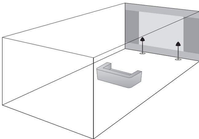
**Exemple 1 :** Cette illustration montre les zones de position, projetées sur le mur situé derrière les enceintes, vues de votre position préférée d'écoute. Les deux enceintes – sur des pieds – sont placées à l'intérieur de la zone de position 1 (zone gris clair) et le commutateur *POSITION* doit être réglé sur 1 sur les deux enceintes.
